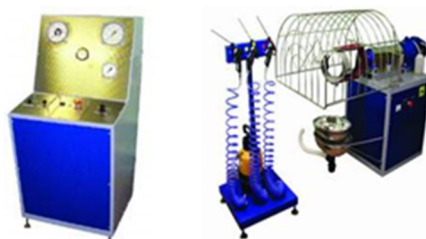
Рис. 5. Освидетельствование и ремонт баллонов высокого давления, используемых в средствах индивидуальной защиты органов дыхания
